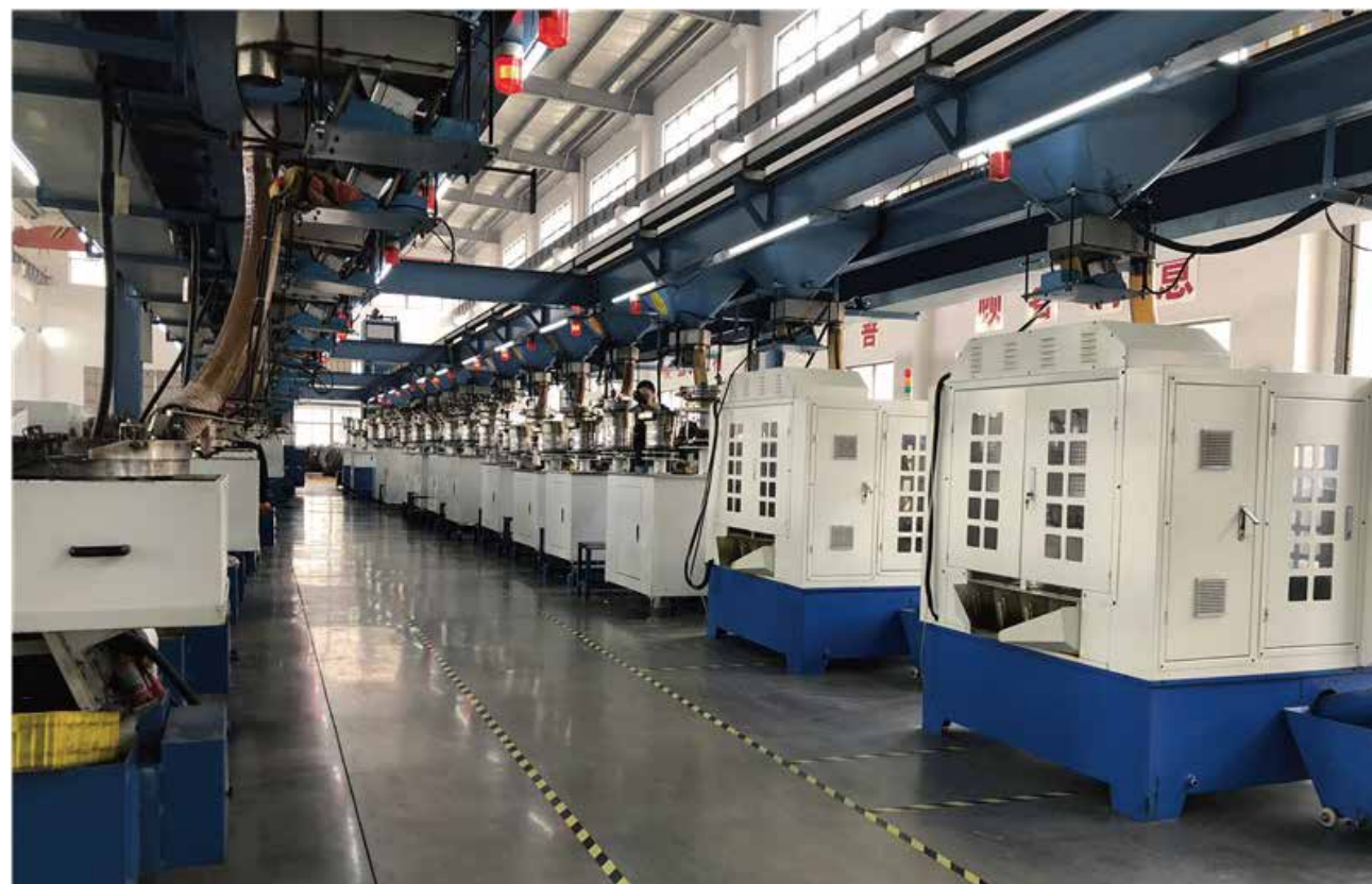
由几十台螺纹搓丝机组成的自动上料生产线大幅提高了生产效率，同时节省了人工成本。 Fully Automatic Thread Rolling Line Greatly Improves The Production Efficiency and Saves The Cost.
