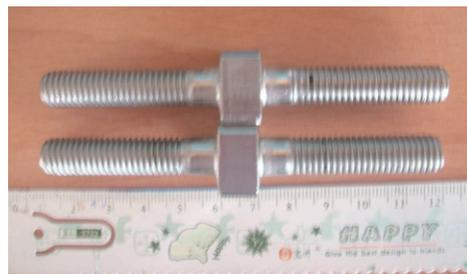
圖一：M10-1.5×101.5 不銹鋼雙頭牙螺絲外觀
