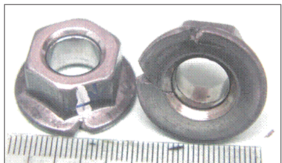
圖5 凸緣螺帽冷打(鍛)硬裂
