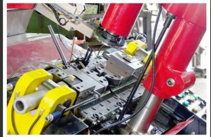
鎡晟機械最新推出的雙油槽夾尾機，專門為複合及白鐵螺絲所設計，荷重大的螺絲在製造時需要添加氯化石蠟，雙油槽油水分離，增加模具壽命，也能增加螺絲品質的穩定度，這台夾尾機可以處理最大的8號鑽尾，鎡晟負責人洪楷翔先生表示：「我們每台機台都是客製化機台，除了鑽尾機、拉釘機、壁虎機我們都能夠製作。」
