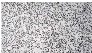
圖2 (a) 熱軋盤元(As-rolled Coil)之晶粒組織經軋延成為軋延方向排列組織 (b) 熱軋盤元(As-rolled Coil)冷卻時雪明碳鐵造成之大片層狀波來鐵金相組織
