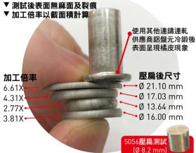
燁鋒研發部劉經理表示:「要將如此大線徑的盤元做完美的晶粒組織細 化難度非常高。加上大線徑盤元主要是使用於螺栓製造,承受的拉伸應力很 大,因此必須使用晶粒組織細化程度更高且無不均匀偏析的高品質材料,才 能創造更好的產品疲勞壽命表現。有別於其他連鑄連軋無法淮行均質熱處 理的材料,我們確保材料內部的合金元素分布均匀,不會集中在局部區域。 另外,材料進行熱軋前也會先車除表面偏析層再進行熱軋延,藉此確保材料 組織純淨度。目前我們生產的大線徑盤元單捲可達250公斤,也是目前全球 熱軋式盤元同業中能供應的最大尺寸,有助於協助客戶在達到高品質目標 外,同時提升產品的良率和提升生產效率。」
