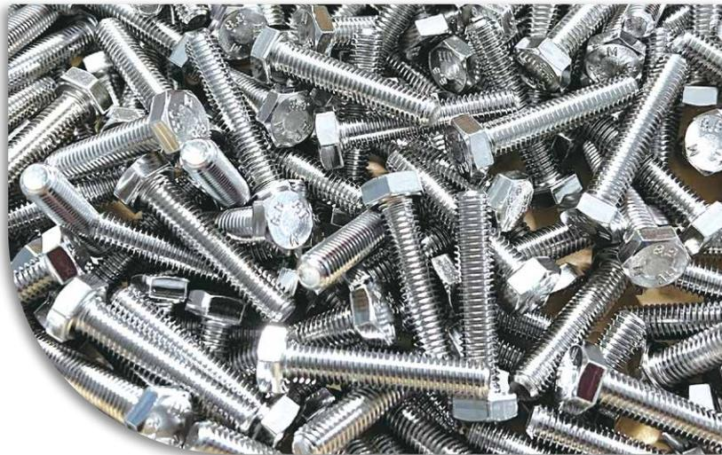
「酸性」鋅鎳電鍍有許多優勢，可產生光亮銀白色表面，電鍍過程的管控比鹼性製程容易，電鍍效率更高，成本更便宜，防鏽性能可等同酸性製程，實現 1,500 小時以上無紅銹。頂吉興這道鹼性製程，可幫助扣件業者將過去把白皮出口到國外電鍍的訂單留在台灣處理，大幅提升入單率，對於今年以來面臨通膨與高值轉型升級壓力的業者來說將是及時雨。
