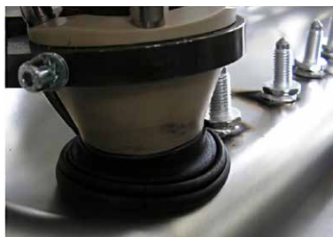
圖 2. 焊接螺柱最佳方向的氣罩和二次保護套。
