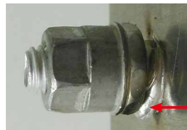
圖 3. 熱鋁圓角在焊接過程中會因重力作用滴落，如圖呈 90 度。
