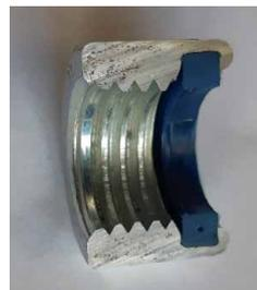
如這些圖所示，DIN 985 螺帽由兩部分組成。鋼製螺帽和塑膠擋圈被壓製在螺帽端口上 (圖2)。
