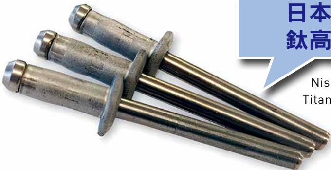
Nissen Corporation 公司推出日本首創鈦高壓盲鉚釘「N Valve Titanium」，專為極薄鈦材設計，具備大直徑背面座屈結構，有效保持基材，提升接合強度。不僅適用鈦材接合，更適合高耐腐蝕需求部位，完美發揮鈦輕量、耐蝕優勢。該產品針對鈦材常見的極薄板特性，採用大背面座屈徑形狀，大幅強化薄板接合效能。無論輕量化車輛、飛行體、航太領域，或醫療器械、化工設備、廠房設施，皆能充分活用鈦材特性，提供優異固定解決方案。
