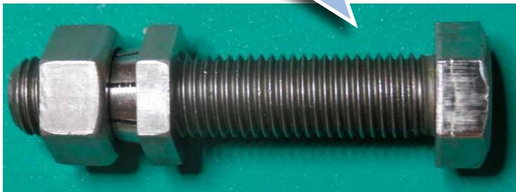
日本 YS Corporation 公司開發的「Tentacle ® Nut」防鬆螺帽，源自長年螺絲研究，徹底解開螺帽鬆脫成因，產品取得專利並正式擴大市場。該螺帽以章魚觸手般「牢牢纏繞」螺栓的設計，適配 M6、M8、M10、M12、M16 規格市售螺栓，最新新增 M2 尺寸，滿足更多精密應用需求。鬆脫主因是振動導致螺紋間隙累積偏移，「Tentacle Nut」採雙層螺帽結構，上層螺帽緊壓下層突起，填補公差間隙，確保軸線對齊、螺栓無傷害。下層管理扭力與張力，由上而下逆轉輕鬆拆卸。無論製造現場振動機械、遊樂園設施、鐵塔橋梁或高溫無菌環境皆適用，提升安全並免除保養。NAS3350 衝擊試驗下 (30Hz、30,000 次振動) 張力殘存 80% 以上；DIN25201 振動試驗下 (2,000 次) 無脫落，殘張力達 94.3%，遠勝一般螺帽。分析證實無自鬆旋轉，實現單純更換螺帽即打造「永不鬆脫」的螺栓組合。
